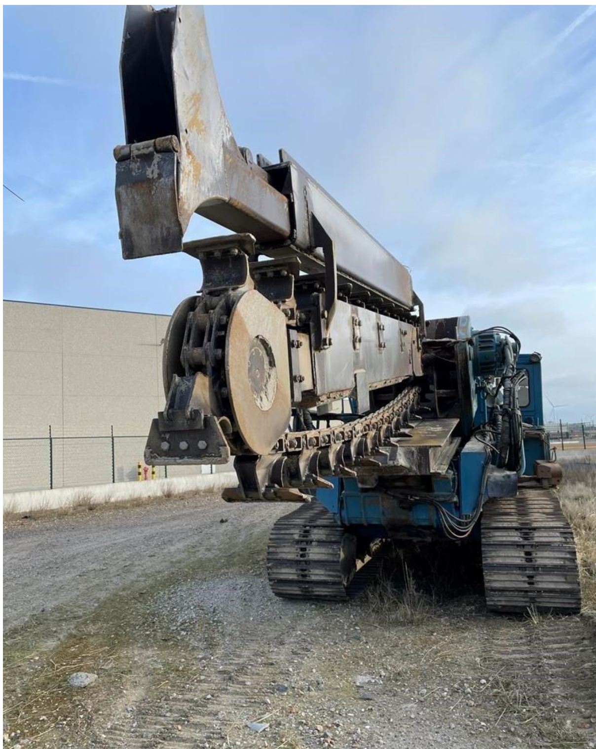
Figuur 147: De machine waarmee het grondwaterkerend scherm aan de Groenknolzone werd aangelegd (foto: Niels De Strooper)
