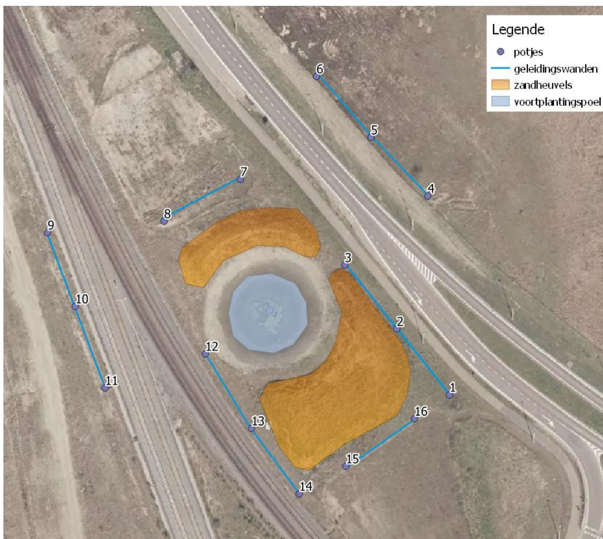
Figuur 107: Overzicht van de proefopstelling aan de Hooghschoorweg met aanduiding van geleidingswanden en nummering van de potjes.
